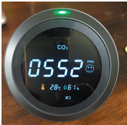
(写真) CO 2 モニター、1000PPMを越えると上部のランプが換気が悪くなっていることを知らせます。価格は5000円ぐらいから。
